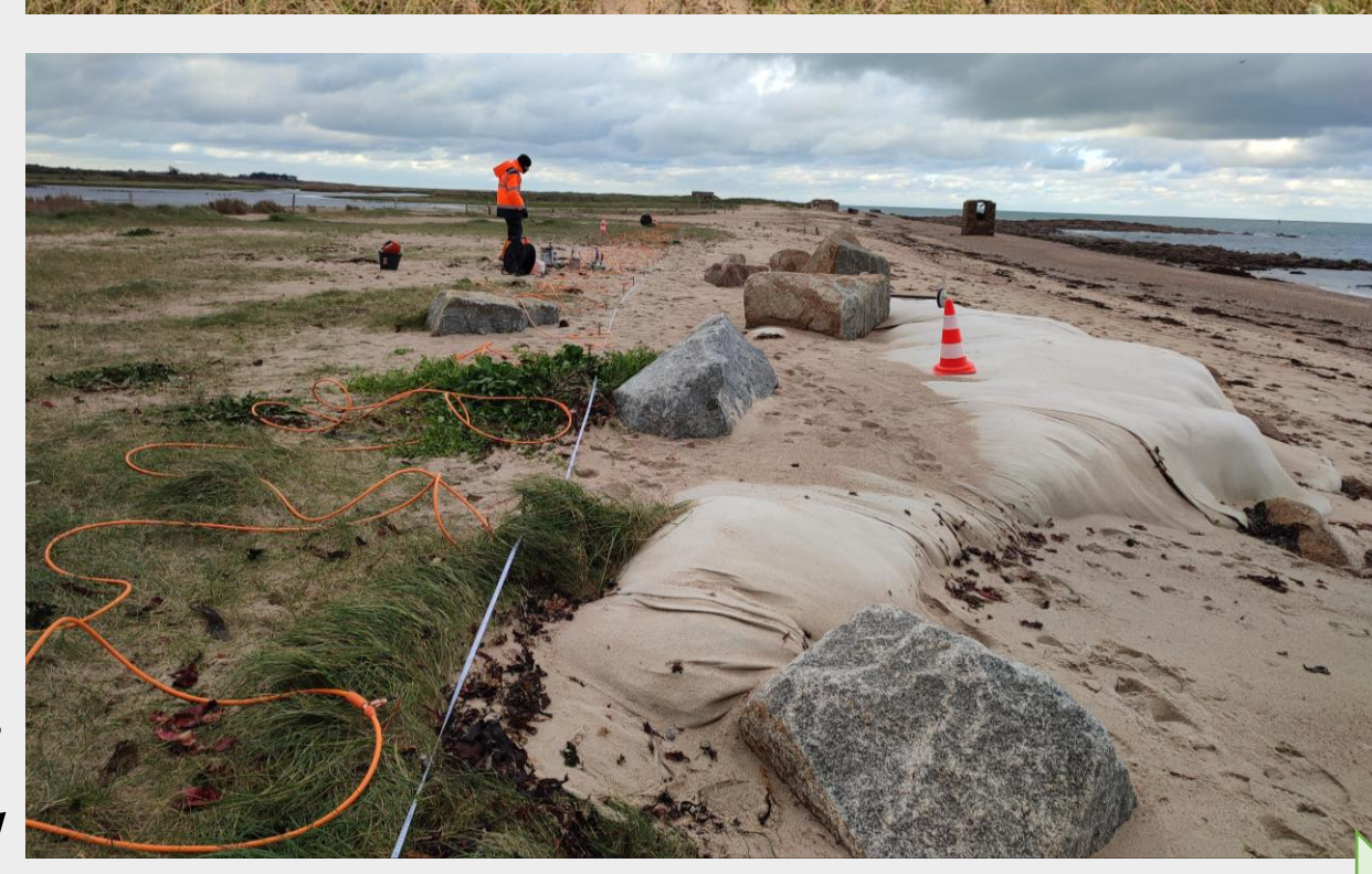
Figure 1: mise en place du CMD sur le site 2 en haut et réalisation d'un profil ERT sur le site 1 en bas
